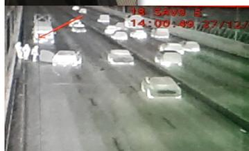
L'opération a consisté à améliorer de façon pérenne l'ensemble de la chaîne : caméras, logiciel d'analyse des images, alarme visuelle au pupitre.
